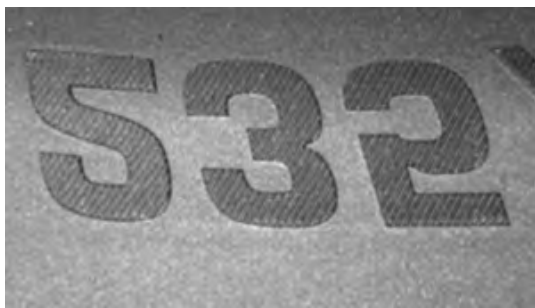
图12 侧板上加工的字体形状与轮胎字体互反
