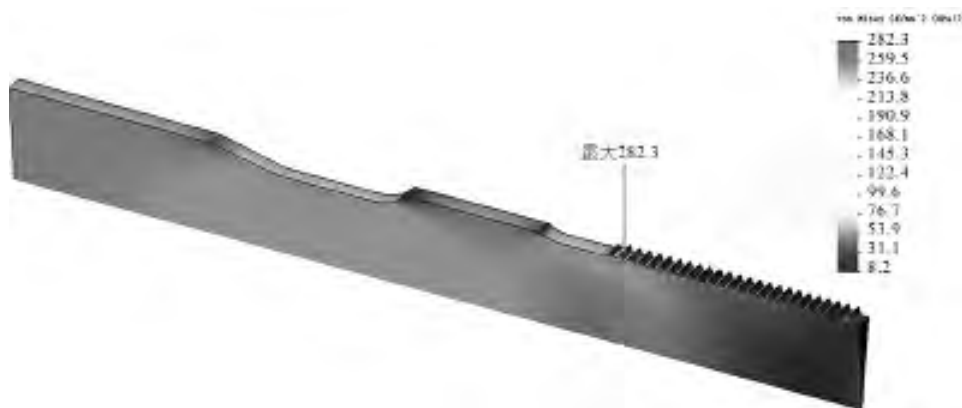
图 7 应力槽直径 110 mm 有限元分析应力结果云图
