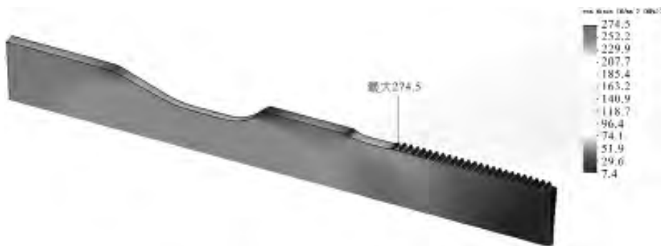
图 8 应力槽直径 90 mm 有限元分析应力结果云图
