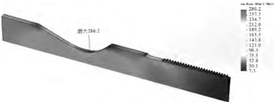
图 9 应力槽直径 70 mm 有限元分析应力结果云图
