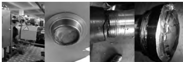
图 1 注塑机拉杆失效实物图
