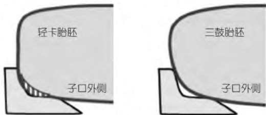
图6 两鼓轻卡成型机和三鼓轻卡成型机胎胚子口形状对比
