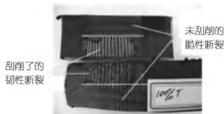
图 5 包含管道已刮削和未刮削区域的 EF 接头试样剥离脱黏试验结果
