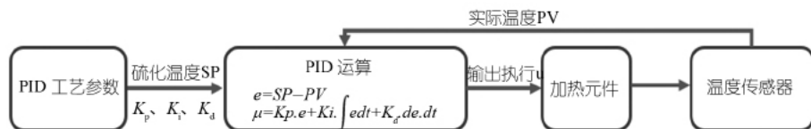
图3 独立加热区 PID 控制逻辑图
