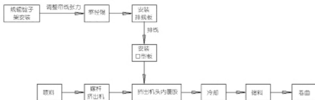
图2 带束条挤出工艺流程
