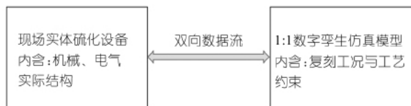
图 3 硫化机数字孪生虚实联动调试模型图
