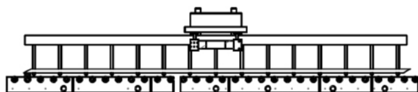
图 3 胎面称重装置导向气缸伸出状态
