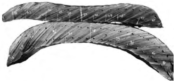
图1 缠绕胶条层间气泡实效图
