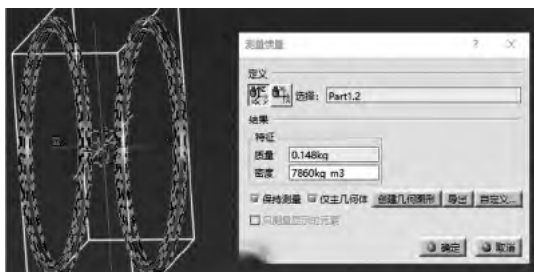
图6 钢丝圈重量测算
