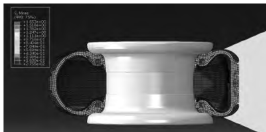
图 13 230×80-100 额定负载应力分布图 (去除钢圈)
