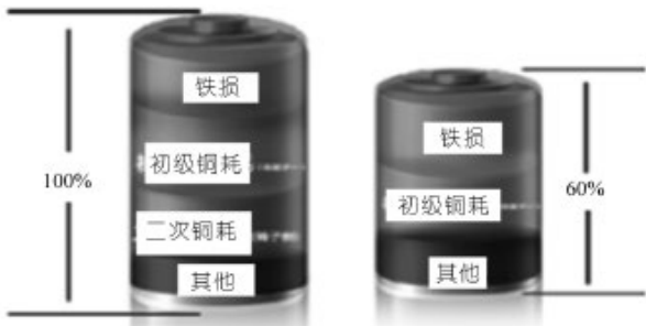
图4 永磁同步电机和异步电机损耗比较
