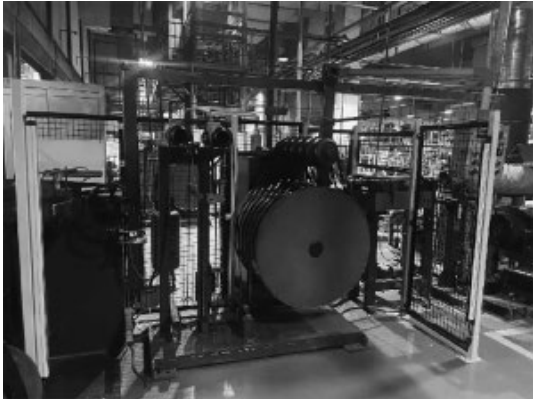
图3 硬隔离防护闭环装置
