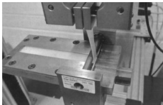
图5 根据 VDI 标准 2019 进行的剥离试验
