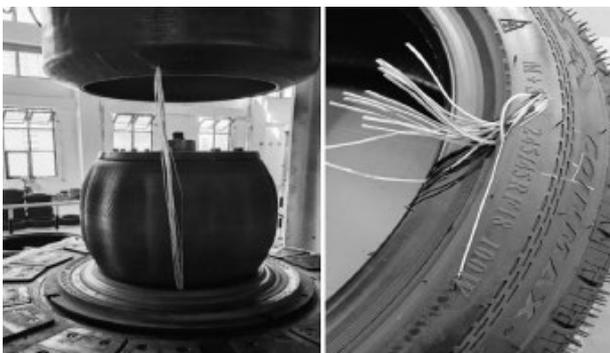
图9 测温埋线现场操作示意图
