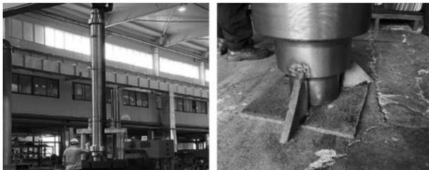
图 7 花键轴热处理常规装炉方式
