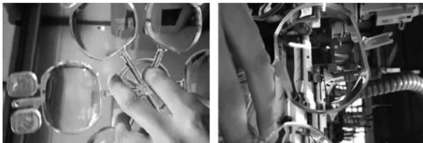
(a) 透镜一出六示意图 (b) 单个透镜示意图
