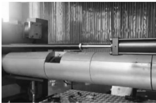
图3 排气式注塑机机筒排气孔示意图
