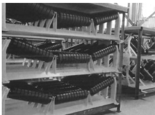
图 1 用于采矿行业的输送机上的脚轮（或实心轮胎托轮），采用包含回收工业废橡胶的再生复合材料制成。
