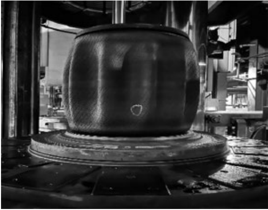
图1 硫化机胶囊内压泄漏
