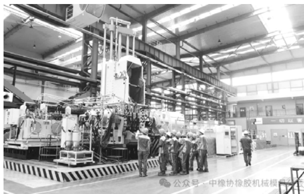
中化橡机益阳基地生产的GN700密炼机试车现场
