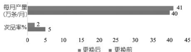
图1 某轮胎厂更换制冷系统前后产品次品率和产量变化图
