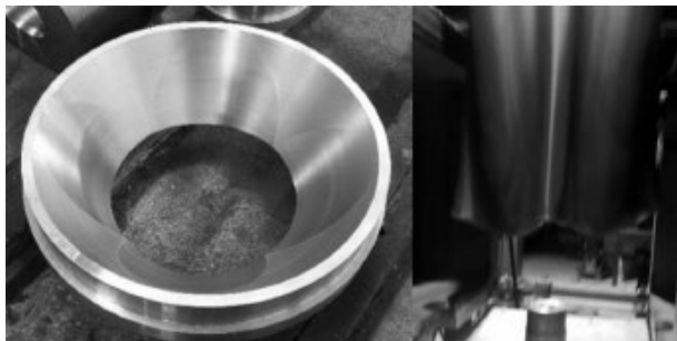
图 7 口模大锥面修形及现场试车
